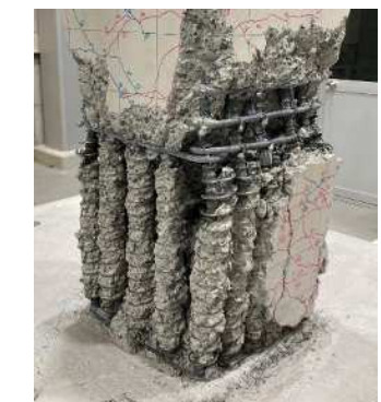
(d) 実験終了後(載荷面・側面側)
