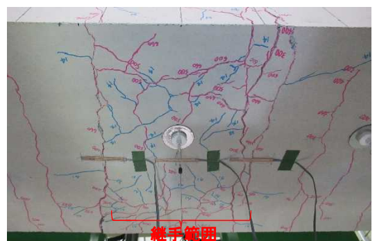
写真-2 試験体 1-3 下面破壊状況 (スパン中央変位 14mm 付近)
