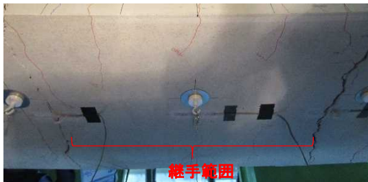
写真-2 試験体 1-1 下面破壊状況 (スパン中央変位 9mm 付近)
