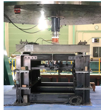
写真-3 静載荷試験の実験装置
