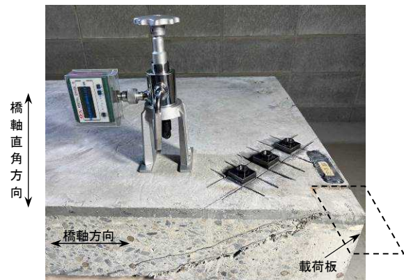
写真-4 引張接着試験状況
