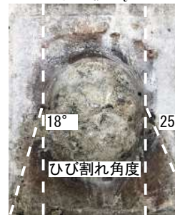
写真一 1 実験後のひび割れの様子
