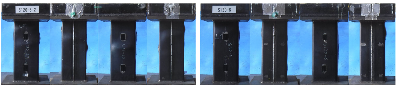
写真-2 最終破壊状況の例 (左: S120-3.2, 右: S120-6)
