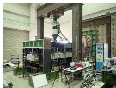
図三 正負交番荷重試験状況
