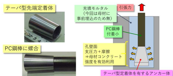
図-3 テーパー型先端定着体
