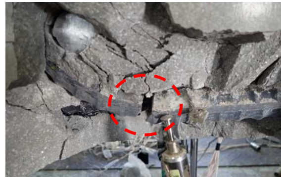
写真-2 軸方向鉄筋の破断状況
