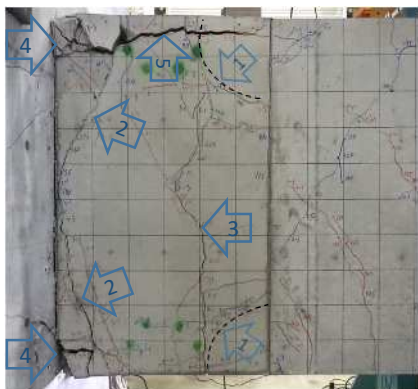
写真-2 破壊の状況 (試験体 4 \delta=74.6\text{mm} )
