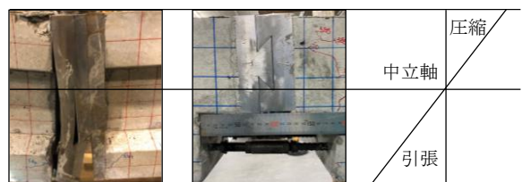
(a) 鋼製シアキーの開口挙動 (b) 開口挙動の抑制 (c) ひずみ分布のイメージ
