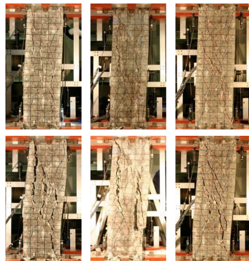
写真－2 破壊状況(上:限界変形時, 下:水平変形6%時)
