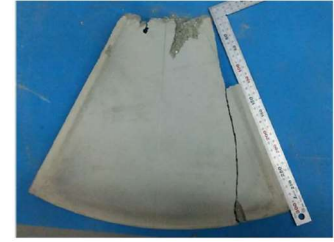
(c) 不均等載荷時の破壊性状 f'_{ck}=55.7N/mm^2 , \phi 319-\phi 882 ②
