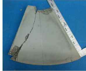
(b) 不均等載荷時の破壊性状 f'_{ck}=55.7N/mm^2 , \phi 216-\phi 584 ②
