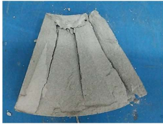
(a) 均等載荷時の破壊性状 f'_{ck}=18.5N/mm^2 , \phi 114-\phi 307 ③
