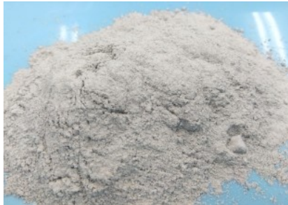
写真-2 使用した廃コンクリートの粉末
