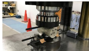
写真-6 簡易曲げ試験の状況
