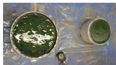
写真-5 ブリーディング・凝結試験用試料への散布
