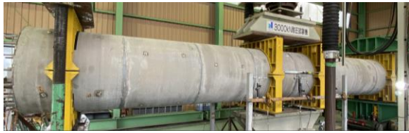
写真-6 接合後の柱状体
