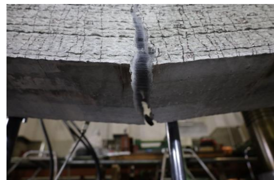
写真-3 終局後の試験体 (II-P)
