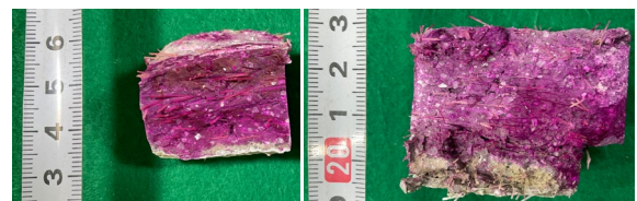
(a) 橋脚積層境 (b) 梁積層境 写真-3 屋外暴露 1 年後の中性化深さ状況
