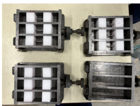
図-3 模擬試験体の型枠
