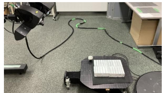
写真－1 3D デジタイザによるはつり形状測定状況
