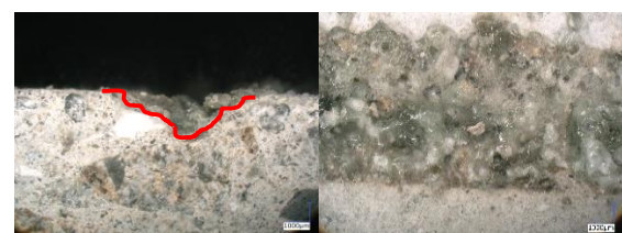
DFS100 10mm/s 90° 照射回数 1 回 dry (a) 表面 (b) 断面
