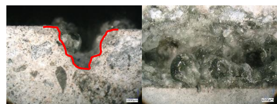
DFS100 10mm/s 90° 照射回数 3 回 dry (a) 表面 (b) 断面
