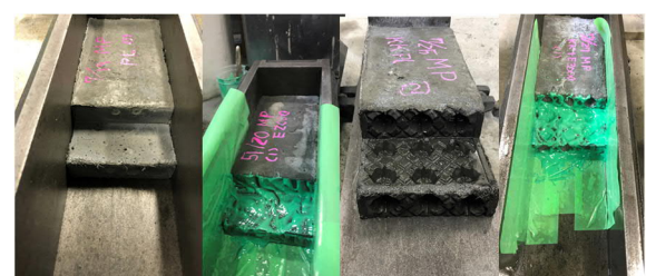
写真-2 かぎ型継ぎ手の試験ケース
