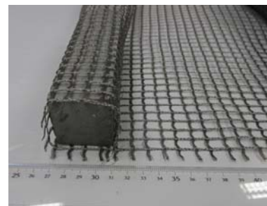
写真-4 使用するシートの変形状況
