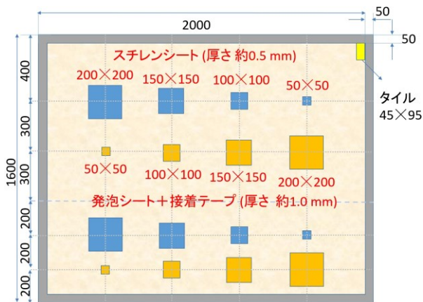
図-4 外壁供試体の模擬欠陥配置図
