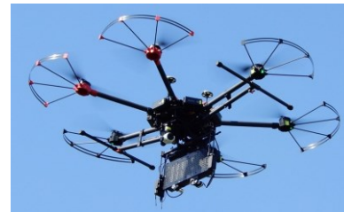
写真-1 音源搭載型 UAV の外観写真
