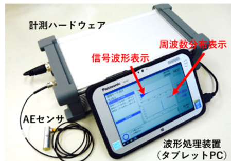
図-1 デジタル打音検査装置
