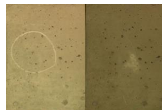
図-1 コンクリートの乾燥時（左）と吸水時（右）
