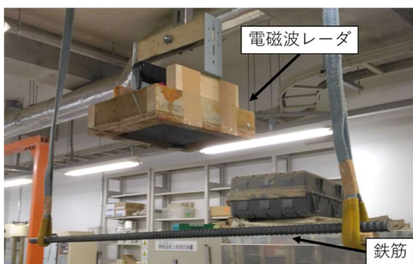
写真-1 空中に吊るした鉄筋の計測状況
