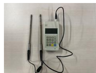
写真-1 電極挿入型電気抵抗式含水率計 (K 社製)
