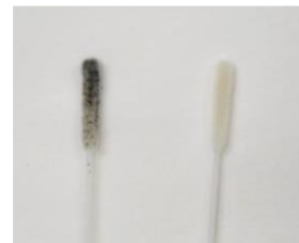
図-2 150×150 mmのコンクリート壁面を擦り取ったスワブスティック
