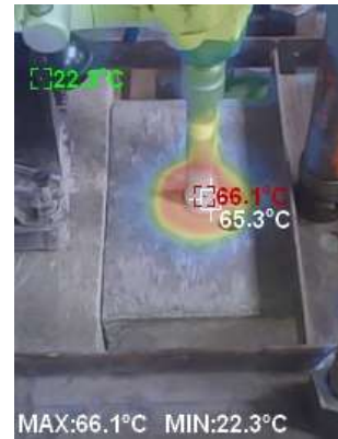
図-5 赤外線サーモグラフィによる表層温度の測定結果
