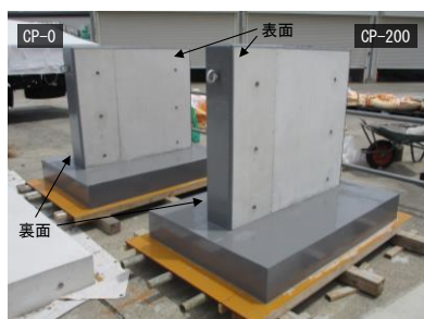
写真-2 塗装後の壁試験体の外観
