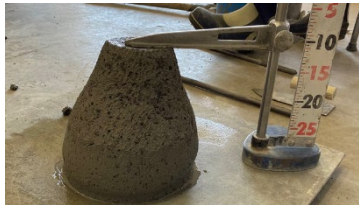
写真-3 石炭灰重量モルタルのスランプ性状 (Sl 11 cm)
