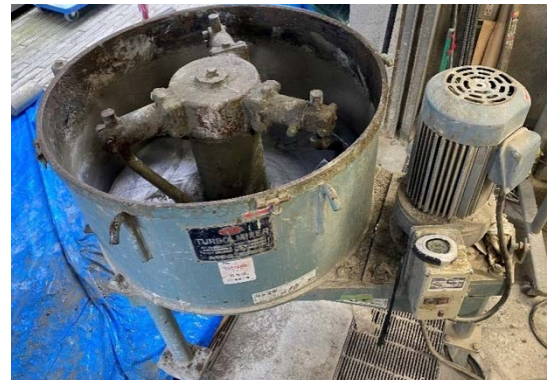
写真-3 練混ぜに使用したパン型ミキサ (55L, 75rpm)
