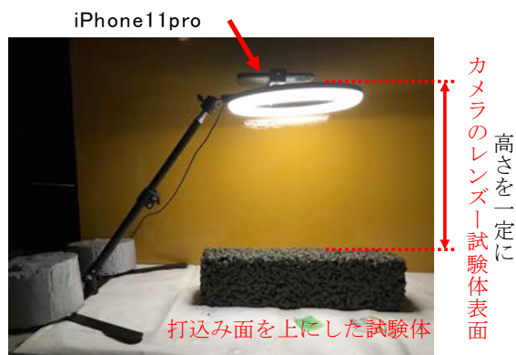
写真-5 表面画像の撮影方法
