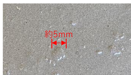
写真-2 練り混ぜ直後のペースト表面状況
