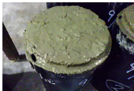
写真-4 アルミ繊維入り供試体の膨張状況
