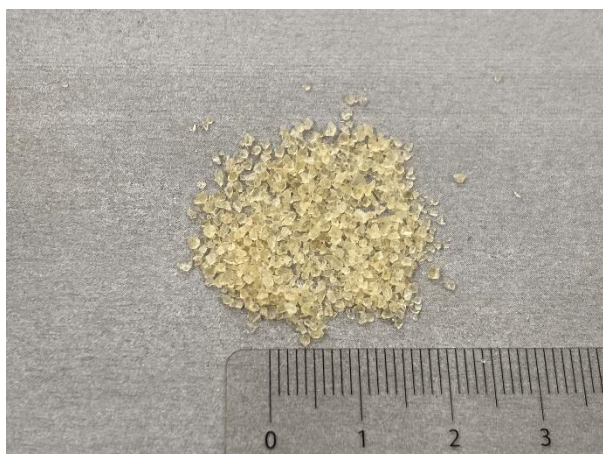
図－1 バクテリアとその栄養分を混合した混和材 (HA)
