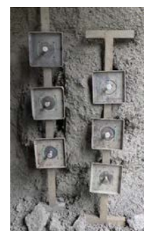
写真－2 コア型枠およびプルアウト試験用型枠
