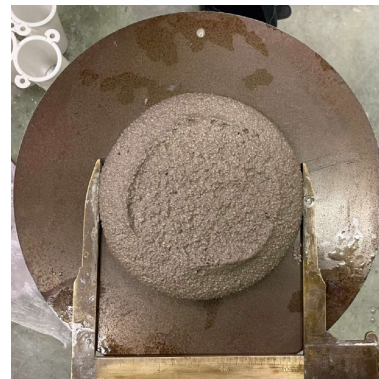
図-8 VGP単体のモルタルの15打フロー
