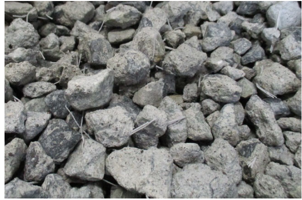
写真-6 配合 No.4 から作製した再生粗骨材
