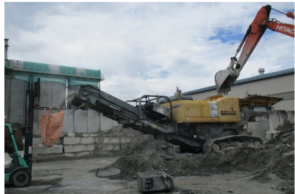
写真-4 再生粗骨材作製の様子 (自走式破砕機)
