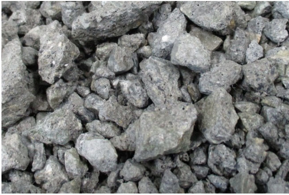
写真-5 配合 No.2 から作製した再生粗骨材
