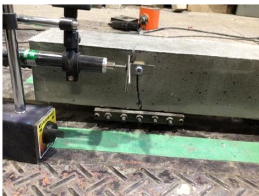
図-15 変位計付近のひび割れ
