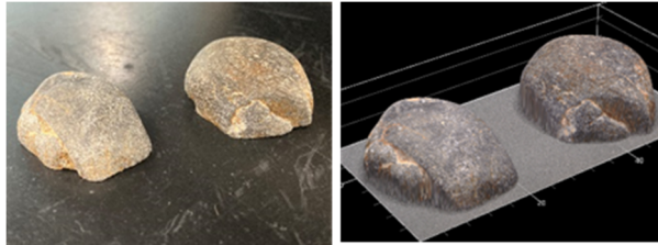
(a) 測定試料 (b) 3D モデル 写真-1 粗骨材試料と 3D モデルの比較 (掛川産砂利 20mm の場合)
