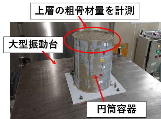
図-5 E_s (材料分離抵抗性) 評価試験
