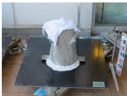
写真-1 静置スランプ試験状況
