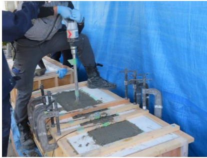
写真-2 振動締め試験状況
