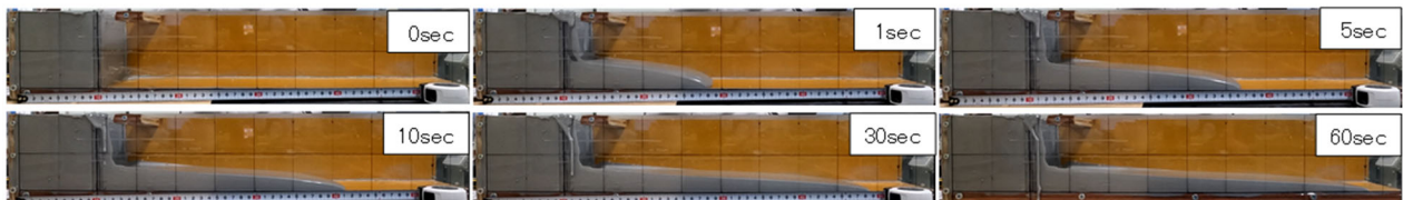
写真-2 流動距離の経時変化 (CP の小型 L 形フロー試験)
