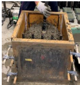
写真-5 模擬型枠
