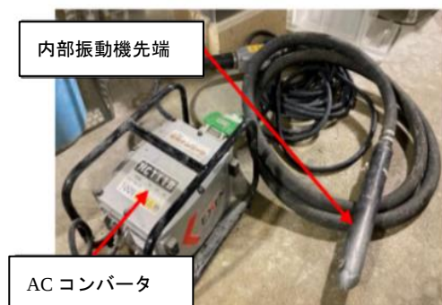
写真-4 内部振動機
