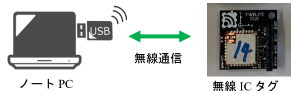
図-1 加速度計測システムの概要
