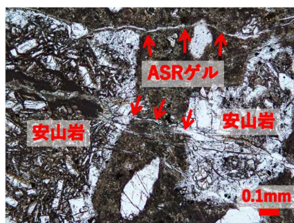
(a) 安山岩(砂利)の ASR ゲルとひび割れ (b) 砂岩(砂)の ASR ゲルとひび割れ (c) 頁岩(砂)の ASR ゲルとひび割れ
