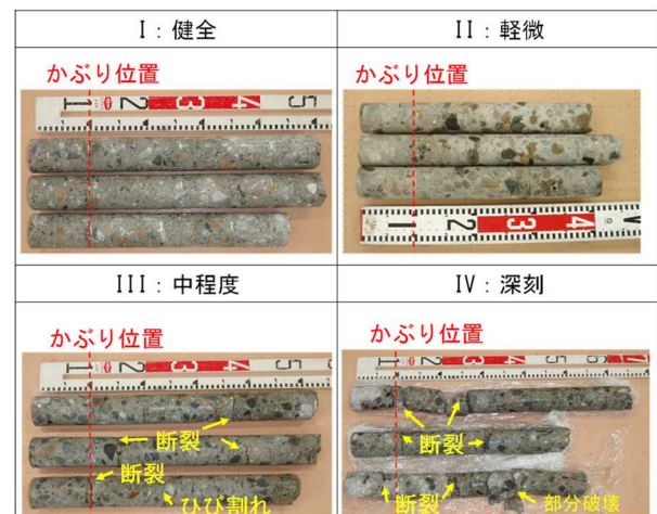
図-3 コアによる劣化状況の評価 6)
