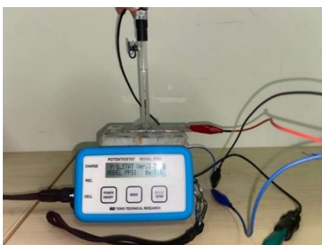
写真-1 分極曲線の測定状況
