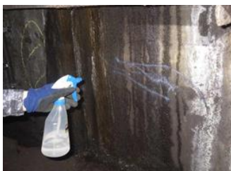
写真-4 硝酸銀溶液の噴霧
