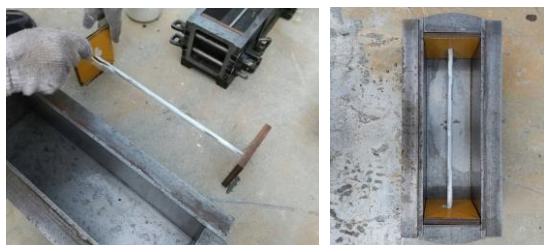
写真-1 鋼製型枠及び長孔のための丸鋼設置状況
