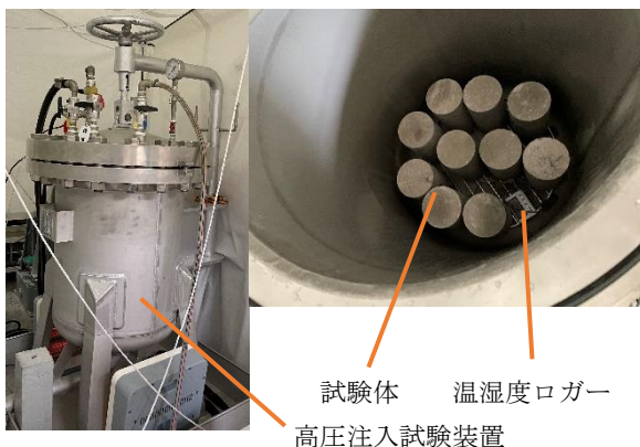
写真-1 高圧注入試験装置及び内部の様子
