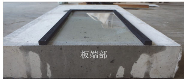
写真-5 排水試験状況
